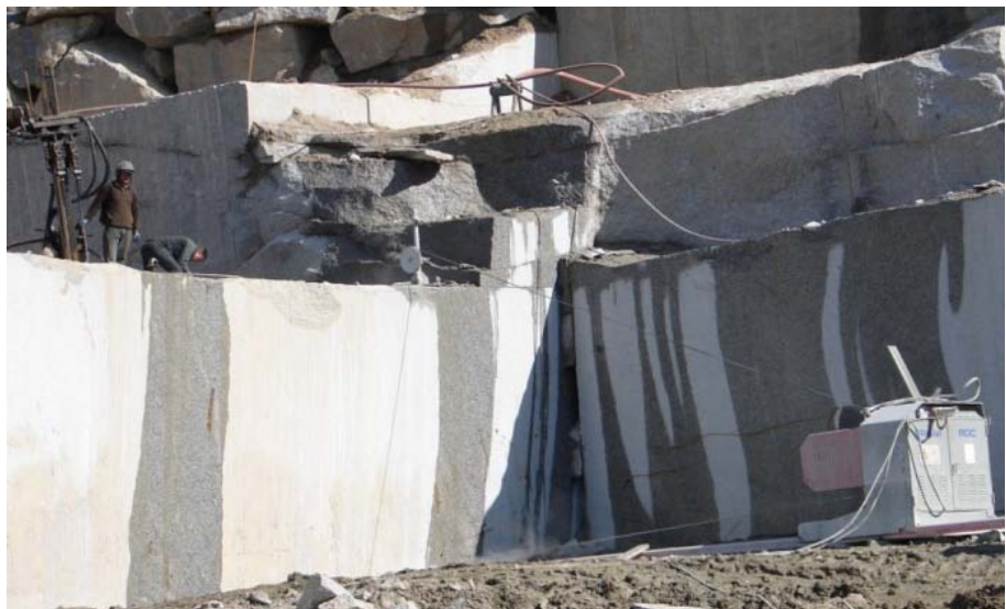
Figura 2.6. Uso del hilo diamantado en las tareas de separación del pastillón
