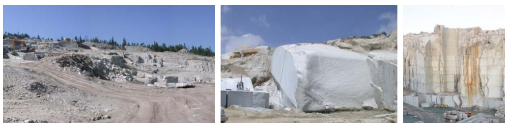
Figura 2.3. Ejemplos de explotaciones, de izquierda a derecha: en zonas superficiales, en zona de bolos y a media ladera
