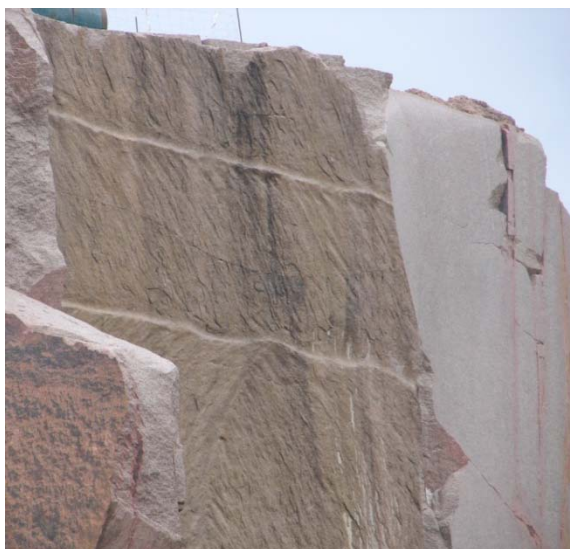
Figura 2.7 Imagen de dos frentes, uno explotado con lanza térmica (izquierda) y otro con hilo diamantado (derecha).
